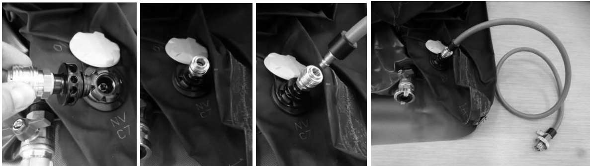
Obrázek č. 4 – Nafukování tlakovou lahví ventilem C7
