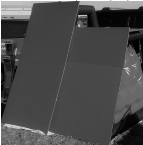
Obrázek č. 9 – Překrytí desek při vytvoření bariéry z více modulů
